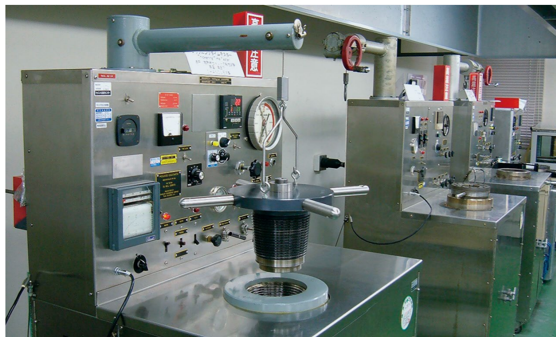
手前/シックニングタイムテスター 後方/圧縮強度試験用供試体の高温高圧養生槽
